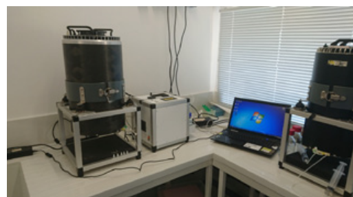
■ Mise en oeuvre des cytomètres automatisés pour phytoplancton (Cytosense) et pour organismes non photosynthétiques (Cytopro avec son module de marquage automatique de cellules).
