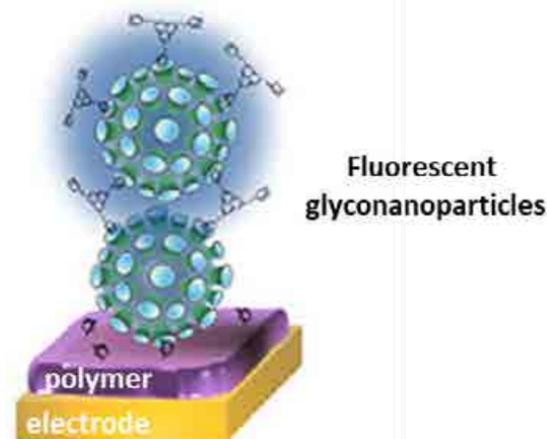
■ Figure 2 : Fonctionnalisation d'électrodes par des glyconanoparticules fluorescentes auto-assemblées.
